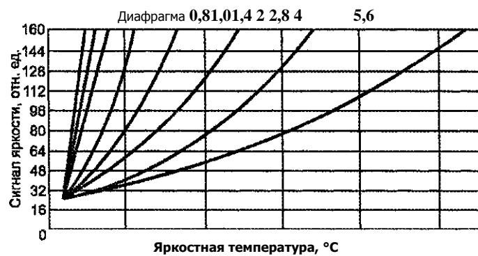
Рисунок Б.2 — Градуировочный график пирорадиационной камеры с фильтром № 2
