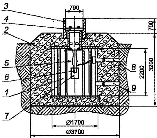
1 — корпус стальной; 2 — оболочка железобетонная; 3 — цилиндр направляющий; 4 — метаемый груз массой до 200 кг; 5 — гибкая подвеска; 6 — дополнительный детонатор с электродетонатором ЭД-8; 7 — заряд; 8 — ввод электрический; 9 — ввод вентиляционный
