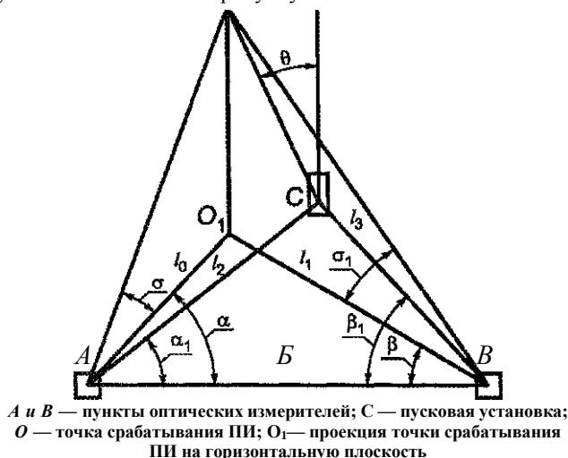
Рисунок 3 — Рекомендуемая схема взаимного расположения пунктов оптических измерителей и пусковой установки
