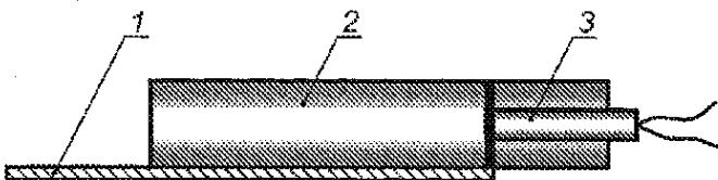
1 — пластина-«свидетель»; 2 — заряд; 3 — электродетонатор
