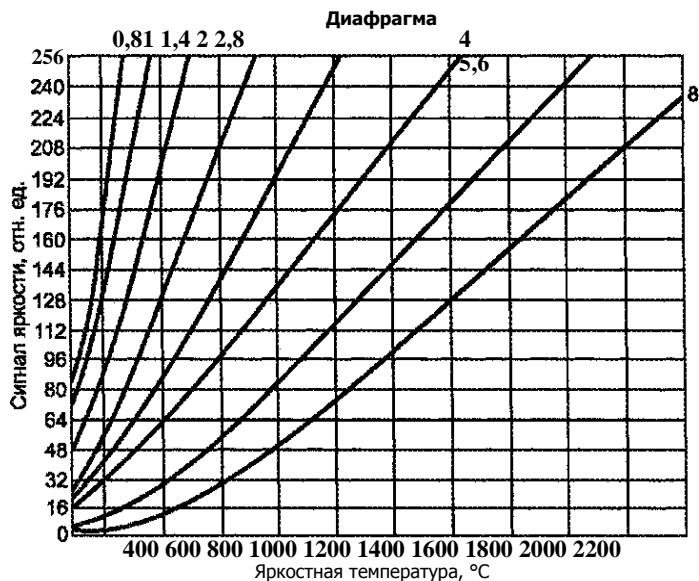
Рисунок Б.1 — Градуировочный график пирорадиационной камеры с фильтром № 1
