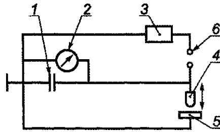
1 — источник электрического тока; 2 — киловольтметр; 3 — блок конденсаторов; 4, 5 — разрядные электроды; 6 — переключатель
